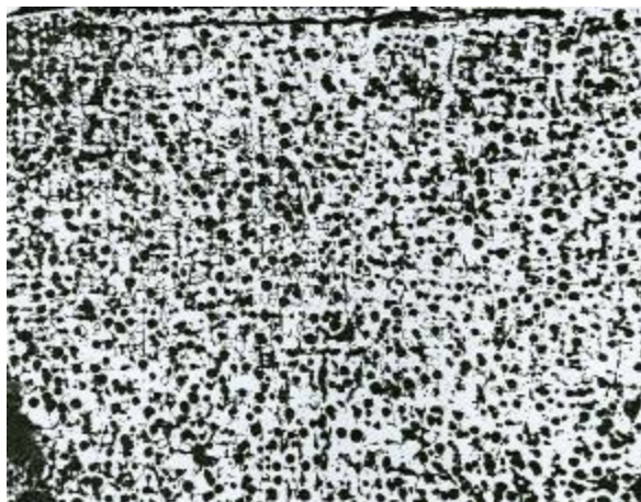
Рис. 3.2 Примерная структура чугуна с шаровидным графитом при увеличении шлифа в 100 раз
