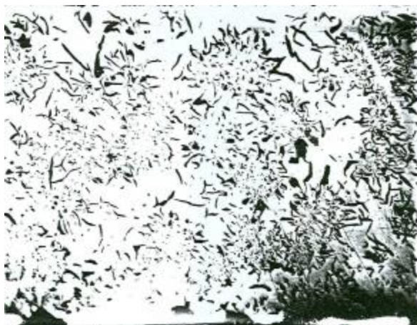
Рис. 3.1. Примерная структура серого чугуна при увеличении шлифа в 100 раз
