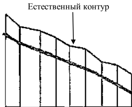
Рисунок 5.5 Трубопровод с постоянным уклоном.
