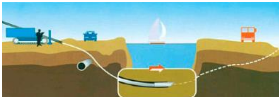
Рисунок 6.18 Бурение пилотной скважины.
