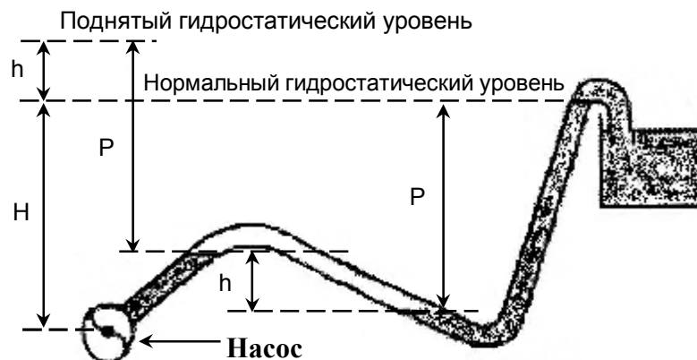
Рисунок 5.4 Условия в напорном трубопроводе.
