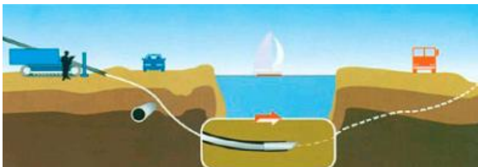
Рисунок 6.18 Бурение пилотной скважины.
