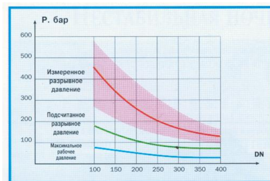
Рисунок 5.2 Фасонные части из ВЧШГ. Давление.
