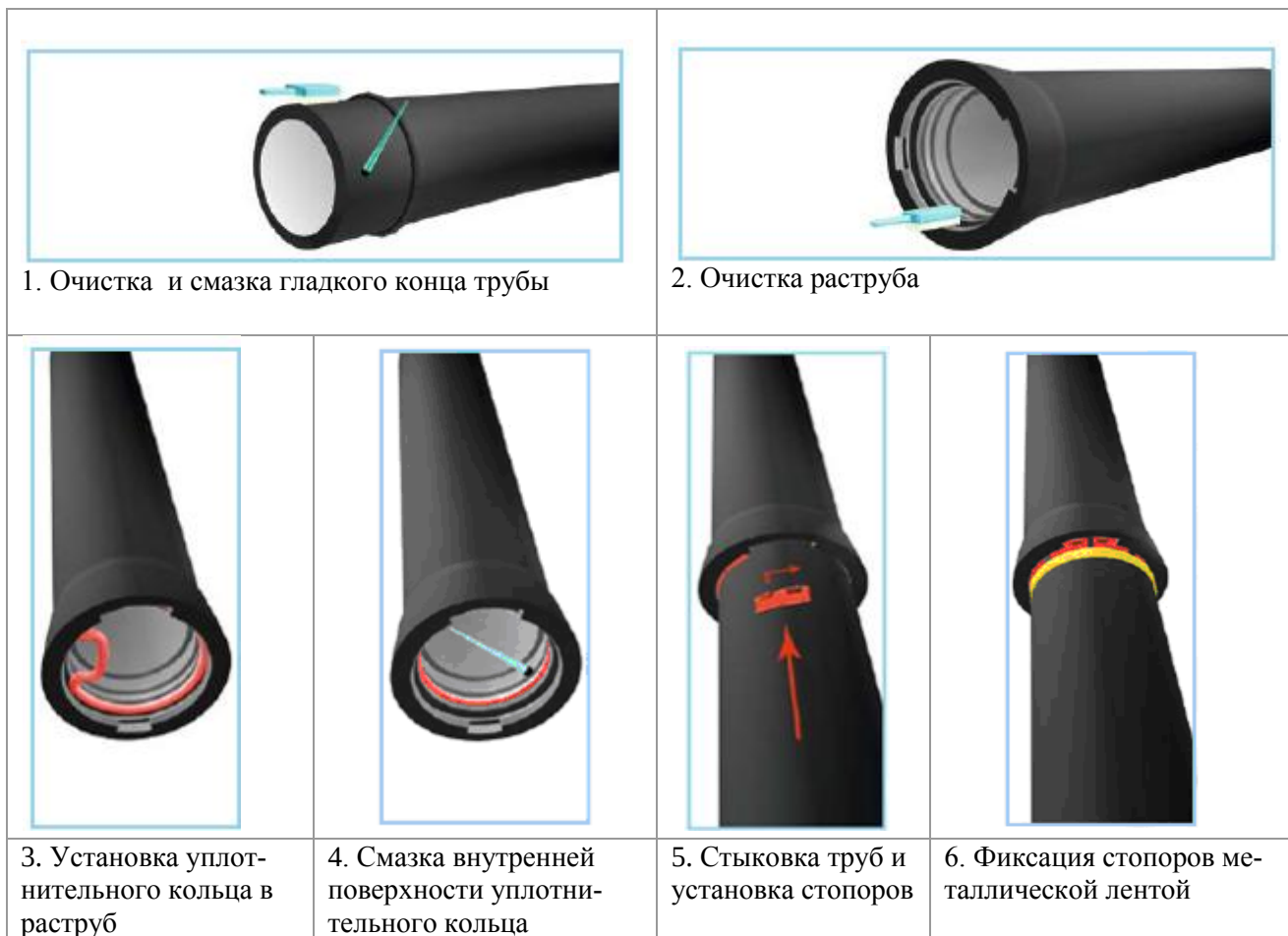
Рисунок 6.6 Монтаж труб с соединением RJS.
