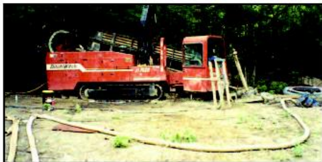
Рисунок 6.17 Прокладка трубопровода методом горизонтально направленного бурения.
