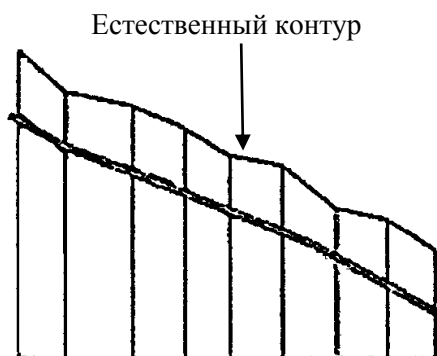
Рисунок 5.5 Трубопровод с постоянным уклоном.
